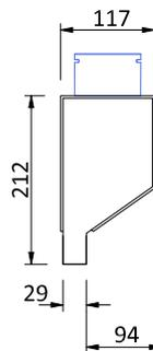
**sezione con angolari installati**
