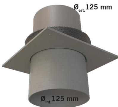
**fig.2** Prolunga telescopica nella sua massima escursione possibile al di sotto della piastra (pari a 60 mm di spessore di cartongesso)
