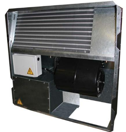
Circuito frigorifero: evaporatore e condensatore a tubi in rame e alette in alluminio passo 2,8mm; compressore di tipo alternativo ermetico, con dispositivi di protezione termica e con coibentazione acustica, montato su antivibranti.
