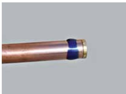
FIGURA 7. APPLICAZIONE PREP: applicare il prep in maniera omogenea e in quantità sufficiente per bagnare la superficie di contatto.
