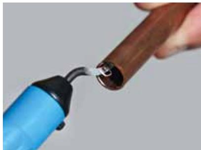
FIGURA 1. SBAVATURA: è necessario ripulire il tubo da tutte le bave.
