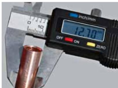
FIGURA 4. VERIFICA DIAMETRO: questa operazione è indispensabile se non si ha la certezza della taglia esatta del tubo.
