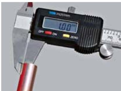
FIGURA 5. VERIFICA SPESSORE: questa operazione è indispensabile se non si ha la certezza dello spessore esatto del tubo.
