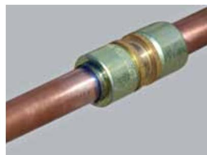
FIGURA 12. GIUNTO FINITO: una leggera fuoriuscita di prep è l'indicatore che il giunto è ben riuscito. Dopo la polimerizzazione è possibile pressare l'impianto.
