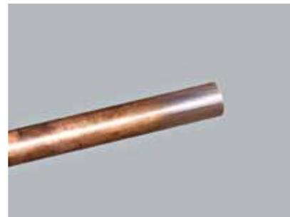
FIGURA 3. SUPERFICIE PRONTA: una volta passata la paglietta il rame è pronto per accogliere il prep, evitare di toccare con le mani la superficie trattata.
