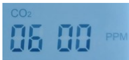
Fig. 28: Esempio di valore misurato con sonda CO 2 / Example of value measured with CO 2 probe
