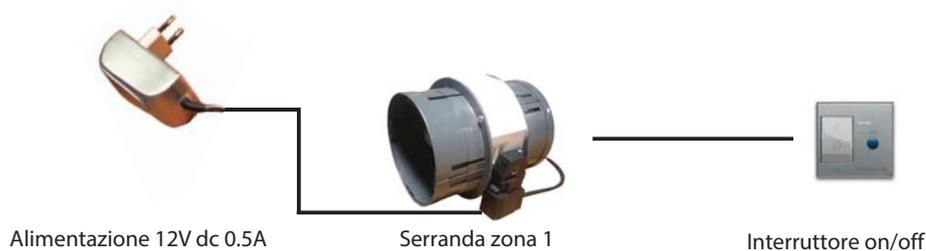
Esempio di CONFIGURAZIONE 1 VIA COLLEGATA CON INTERRUOTORE ON/OFF
